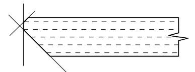
Figure 4. Mitered edge (45°)
